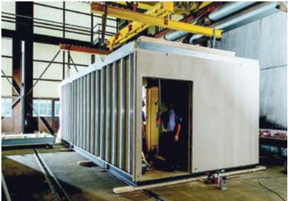
Beispiel eines Moduls in Stahl-Leichtbauweise.
